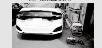
FCVからの給電：老人ホームでエアコンや小型蓄電池の充電に使用 出典：本田技研工業株式会社
