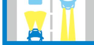
前方の先行車や対向車等を検知し、ハイビームとロービームを自動的に切り替える自動切替型前照灯、ハイビームの照射範囲のうち当該車両のエリアのみを部分的に減光する自動防眩型前照灯のほか、配光可変型前照灯があります。
