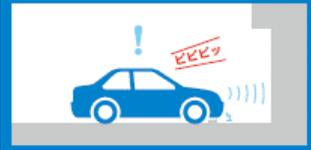
停止時や低速走行時に、車載レーダー等が前方や後方の壁や車両を検知している状態でアクセルを踏み込んだ場合には、エンジン出力を抑える等により、急加速を防止します。
