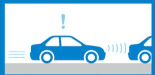
車載レーダー等により前方の車両や歩行者を検知し、衝突の可能性がある場合には、運転者に対して警報します。さらに衝突の可能性が高い場合には、自動でブレーキが作動します。
